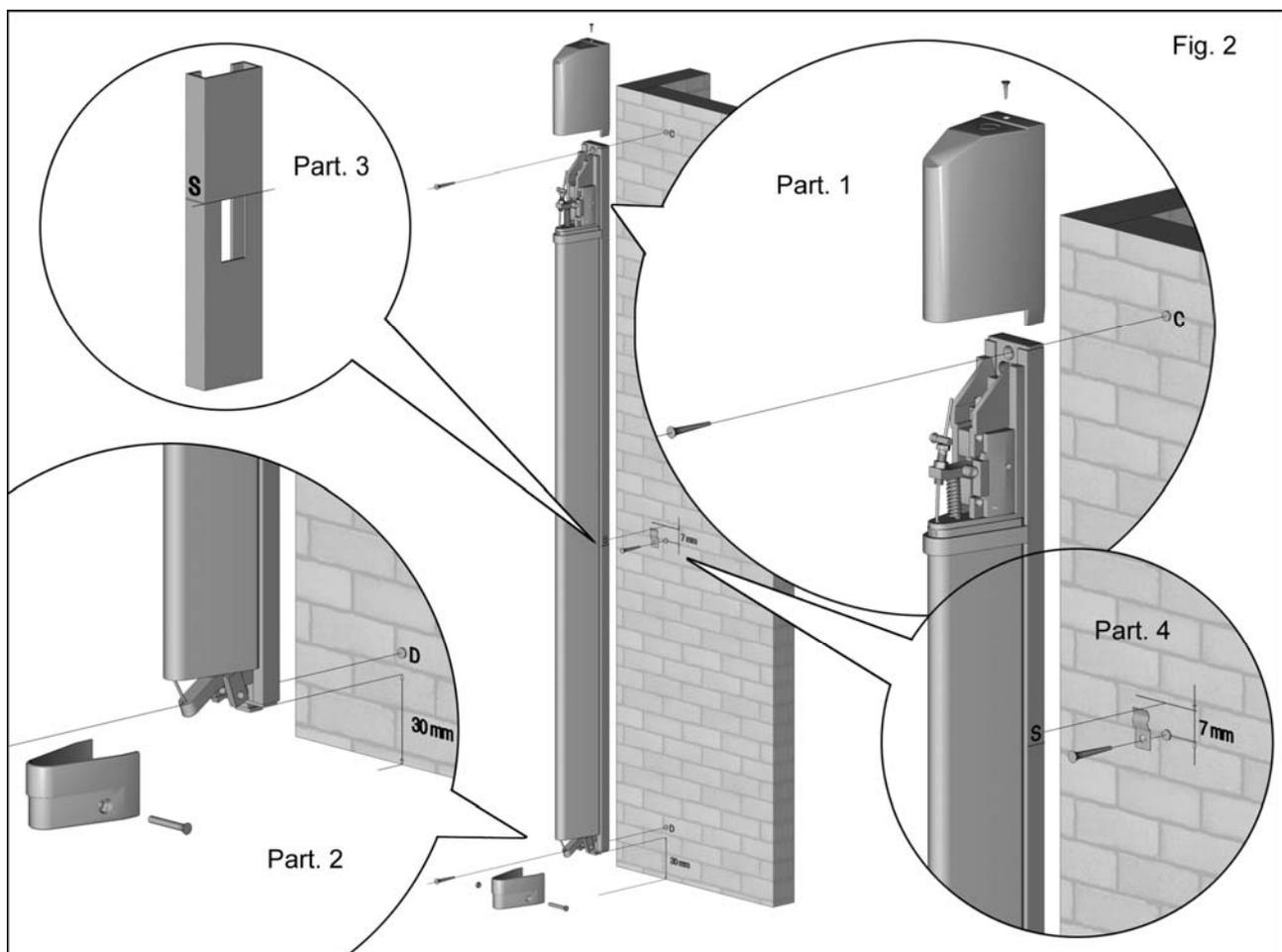
9. Colgar el dispositivo sobre el resorte y proceder con la fijación de los tornillos.
